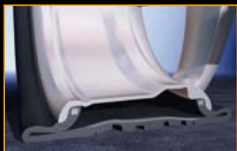
Standardowa opona po całkowitej utracie ciśnienia: wkrótce ulega zniszczeniu
