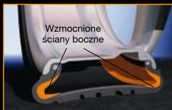
Opony SSR: pozwala na kontynuowanie jazdy do 80 km z prędkością do 80 km/h.
