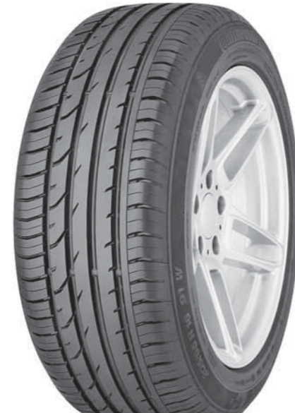
Ejemplo de neumático: 205/55 R 16 91W ContiPremiumContact 2
