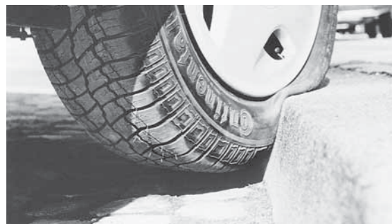
Nota Bordillos y obstáculos similares deben ser sobrepasados muy lentamente y con un ángulo apropiado (frontalmente)
