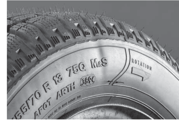
Resultado muy visible del solapamiento de lonas de la carcasa en el flanco
