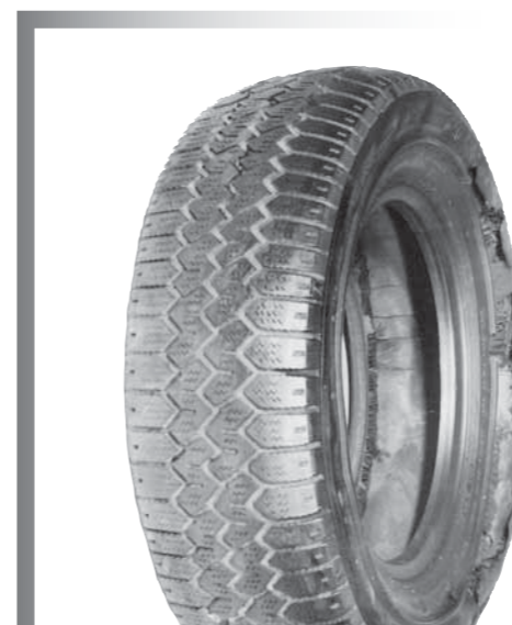
Fuertes e incontrolados calentamientos del neumático debido a conducción con baja presión originarán separaciones estructurales, e incluso disgregaciones de la goma.
