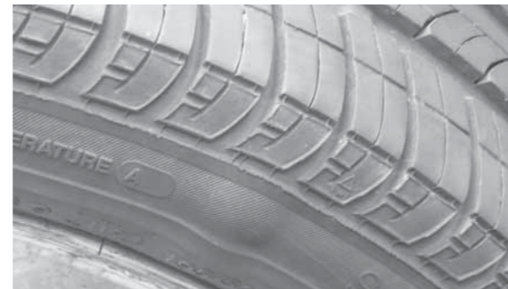
Daño visto desde fuera
