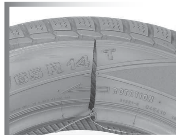
Rotura de un talón debido a tensiones excesivas durante el montaje
