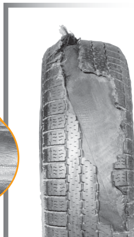
Partes del neumático se han desprendido debido a falta de mantenimiento.
