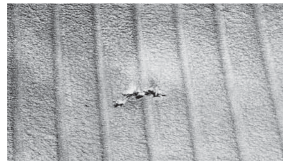
La carcasa ha sido cortada contra la llanta, resultado de un fuerte impacto en el área de contacto (Daño visto desde dentro)
