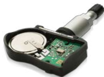
Radmodul des Tire Guard-Reifeninformationssystems
