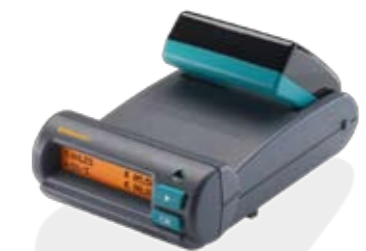
Satellitengestützte Onboard-Unit zur Mauterfassung
