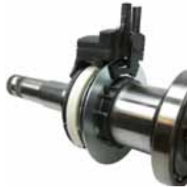
Drehmomentsensor: Integration am Torsionsstab der Lenkung
