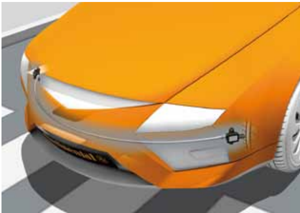
Fußgängerschutzsystem basierend auf Drucksensierung PPS pSAT
