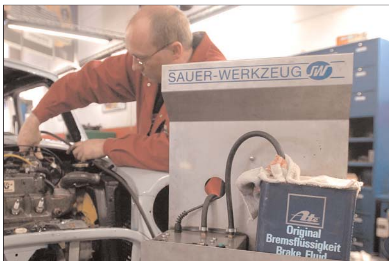
Damit der Tritt nicht ins Leere geht: Jürgen Bosse tauscht im ATE BremsenCenter die Bremsflüssigkeit aus. Zum Sicherheitscheck gehört die Überprüfung der gesamten Bremsanlage. Foto: Continental AG
